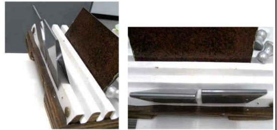
〈磨き鋼板による衝撃試験〉
