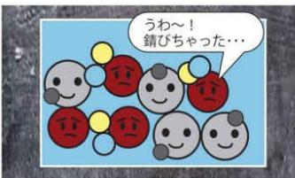
不安定な初期錆は、時間と共に水が介在して酸素と結合を繰り返し、最終的には安定的な錆（酸化鉄）へと変化し、損耗していきます。
